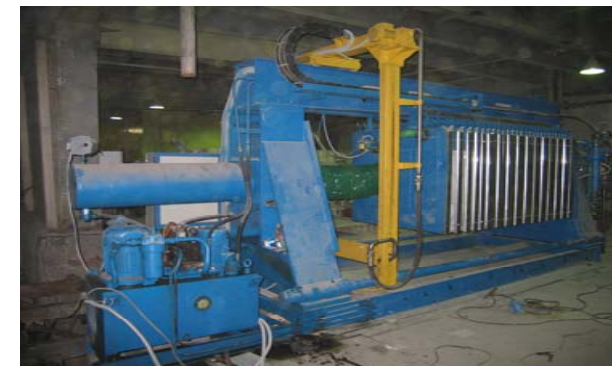
Фильтр-пресс ЧМ 100/30-1200 М, завод «Электроцинк», г. Владикавказ
