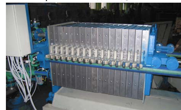
Фильтр-пресс ЧМ 10/30-630 МБ, завод «Электроцинк», г. Владикавказ
